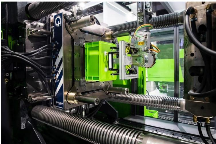
Imagen de portada: la tecnología skinmelt oculta el material reciclado bajo una superficie de material nuevo, por ejemplo en cajas de transporte. (Imagen: ENGEL)
