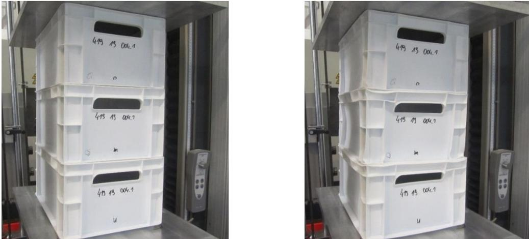
Fig. 3: cajas de transporte utilizadas en el ensayo de apilamiento bajo presión: La imagen izquierda muestra su estado antes de que se iniciara el ensayo y la derecha, después de aplicar una fuerte presión. (Imagen: Centro de Transferencia para Tecnología de Plásticos)
