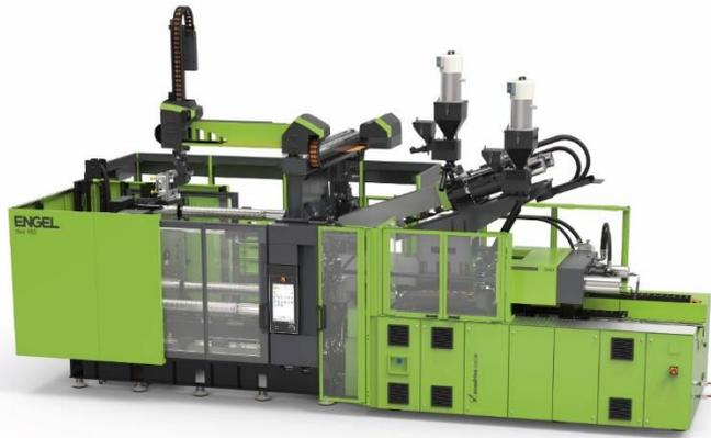
Imagen 1: máquina de varios componentes compacta: En la máquina de moldeo por inyección ENGEL duo, específicamente diseñada para la tecnología skinmelt, la segunda unidad de plastificación para el material de la piel se encuentra situada en ángulo agudo encima de la unidad de inyección horizontal en la que se funde el material reciclado. (Imagen: ENGEL)
